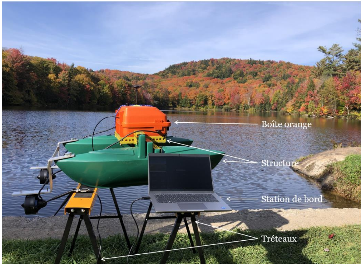
Figure 1 Différentes parties du drone
