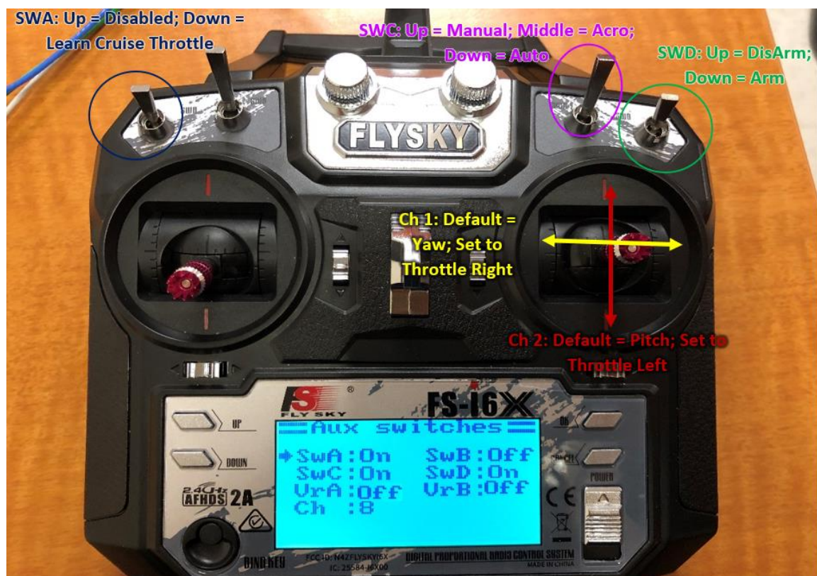
Figure 9 Fonctions auxiliaires – erreur : « CH : 7 » et non « 8 » comme sur la photo!
