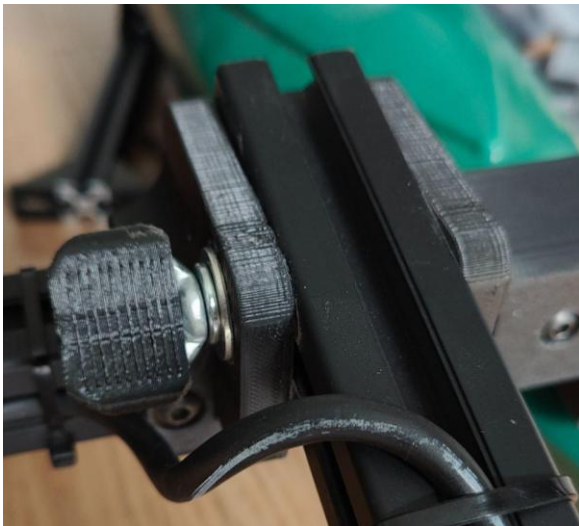
Fixation de la pièce holder_motor_mec de droite (même chose à gauche)
