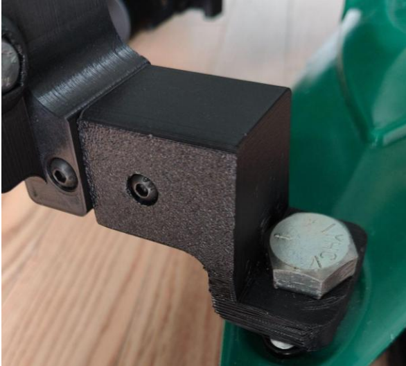
Fixation des pièces 3D holder_struc_back_right et holder_struc_back_left
