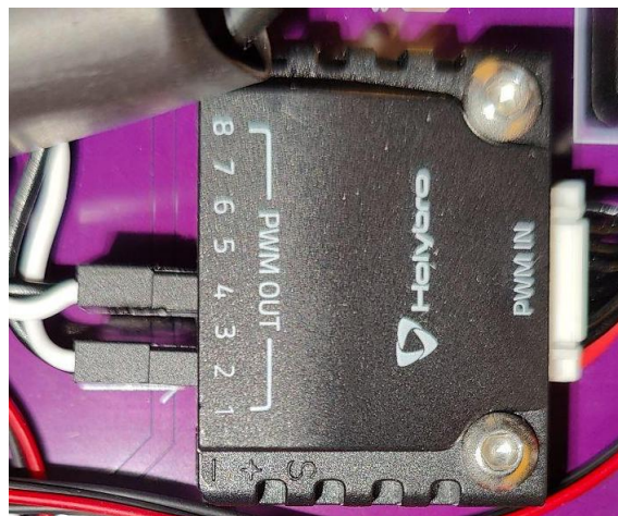
Câblage du module PWM
