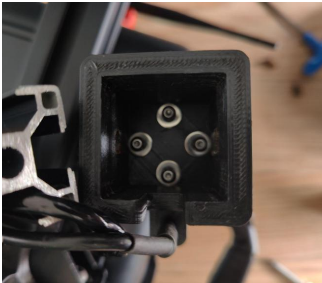
Fixation du sonar et du capteur de température
