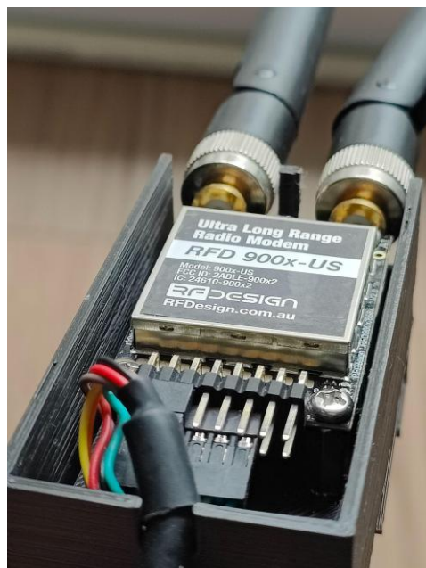
Assemblage du boîtier à module RF
