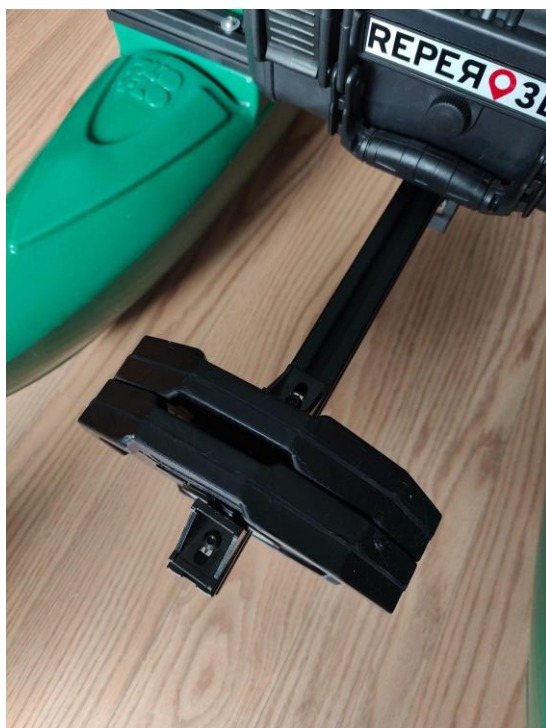
Installation des poids de balancement
