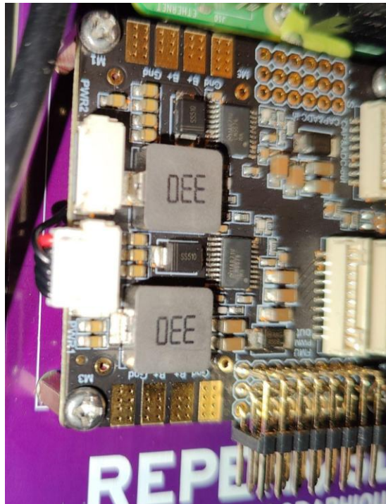
Câblage du module l'alimentation
