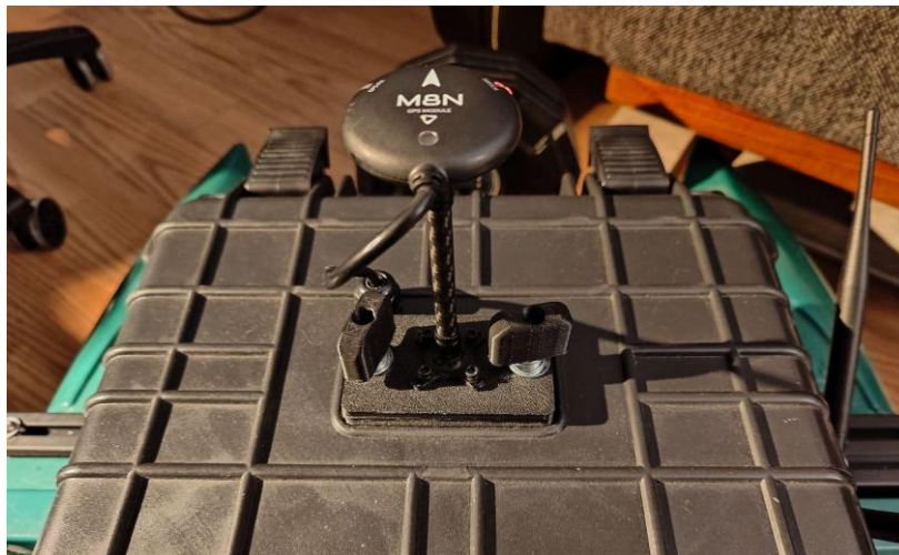
Orientation de l'antenne GPS une fois installée
